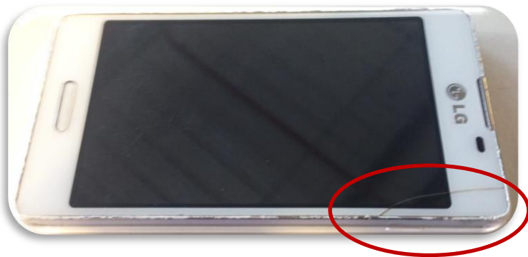
Fissure/ casse sur l'écran ou coque arrière
